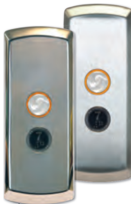
Bottoniera di piano con placca in cromo lucido o satinato. Pulsante cromo lucido con anello di segnalazione arancio. Gemma di segnalazione allarme e indicazioni Braille.
